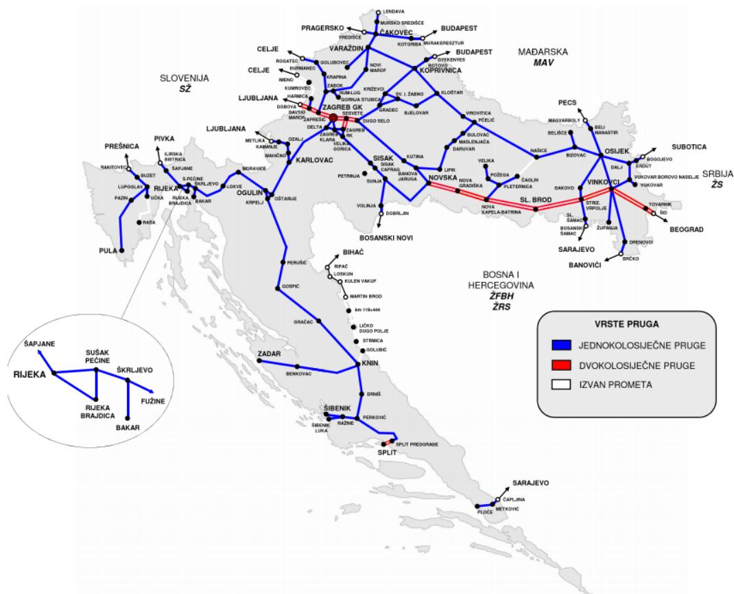
U Republici Hrvatskoj elektrificirano je 980 km mreže željezničkih pruga i sastoji se od izmjeničnog sustava električne vuče 25 kV, 50 Hz u duljini od 977 km te od istosmernog sustava od 3kV u duljini 3 km.
