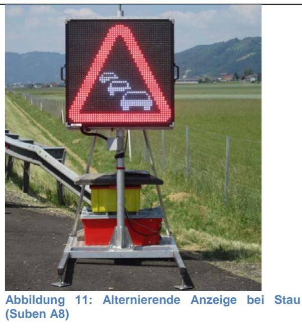
Abbildung 11: Alternierende Anzeige bei Stau (Suben A8)
