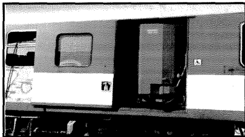
Obrázok 5 Vozeň radu Bdsheer so zdvíhacou hydraulickou plošinou
