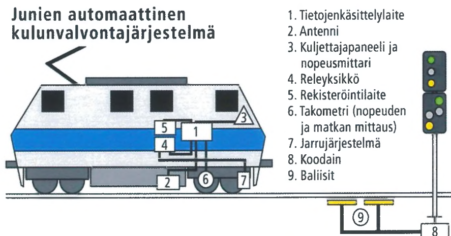
Kuva 1 Junien automaattisen kulunvalvontajärjestelmän veturilaittekomponentit (ks. kuvan nro 1.–7.) ja ratalaittekomponentit (ks. kuvan nro 8.–9.).
